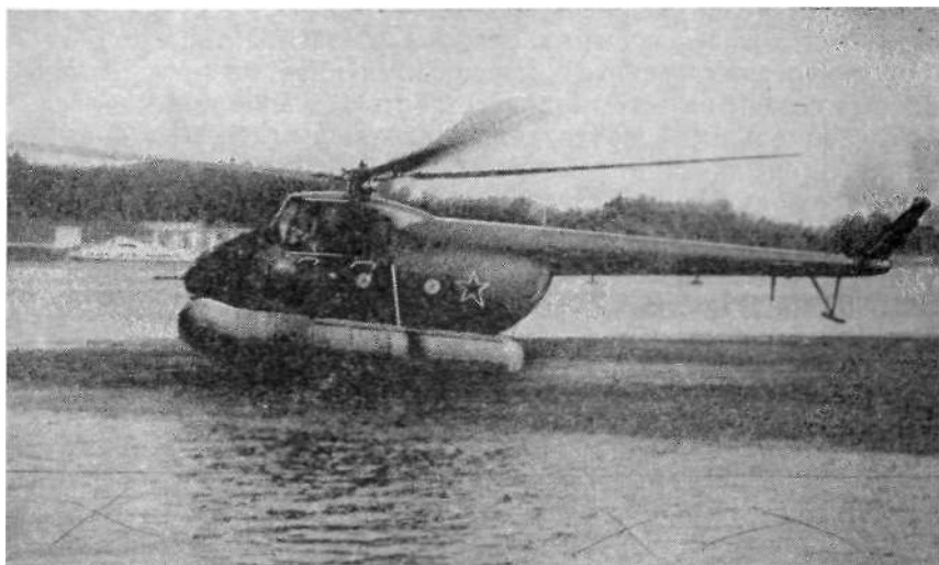
Вертолет Ми-4 с поплавко- вый шасси в процессе лет- ных испытаний
