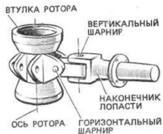
Схема сочленения лопасти к втулке ротора при помощи горизонтального и вертикального шарниров
