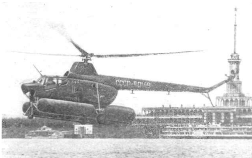
Вертолет Ми-1 с поплавковым шасси в полете во время заводских летных испытаний
