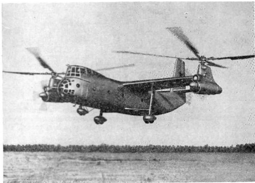
Вертолет комбинированной схемы с двумя турбовинтовыми двигателями — «винтокрыл» Ка-22 (ОКБ Н. И. Камова)
