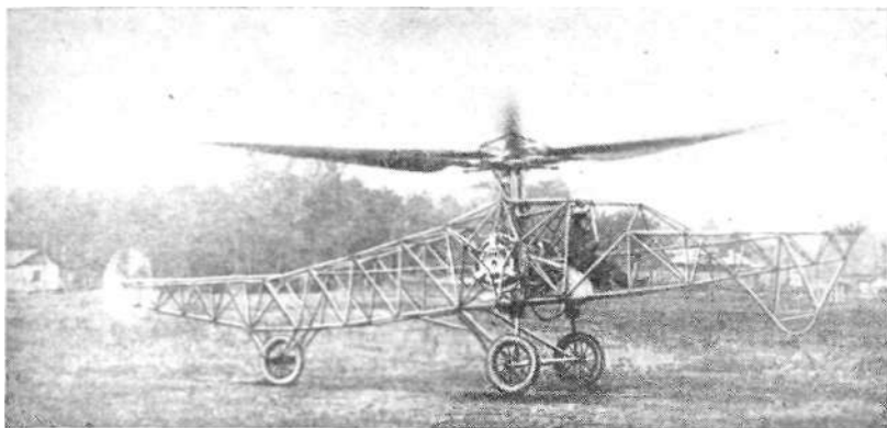
Вертолет ЦАГИ Б-ЭА, переделанный под вариант привязного электровертолета
