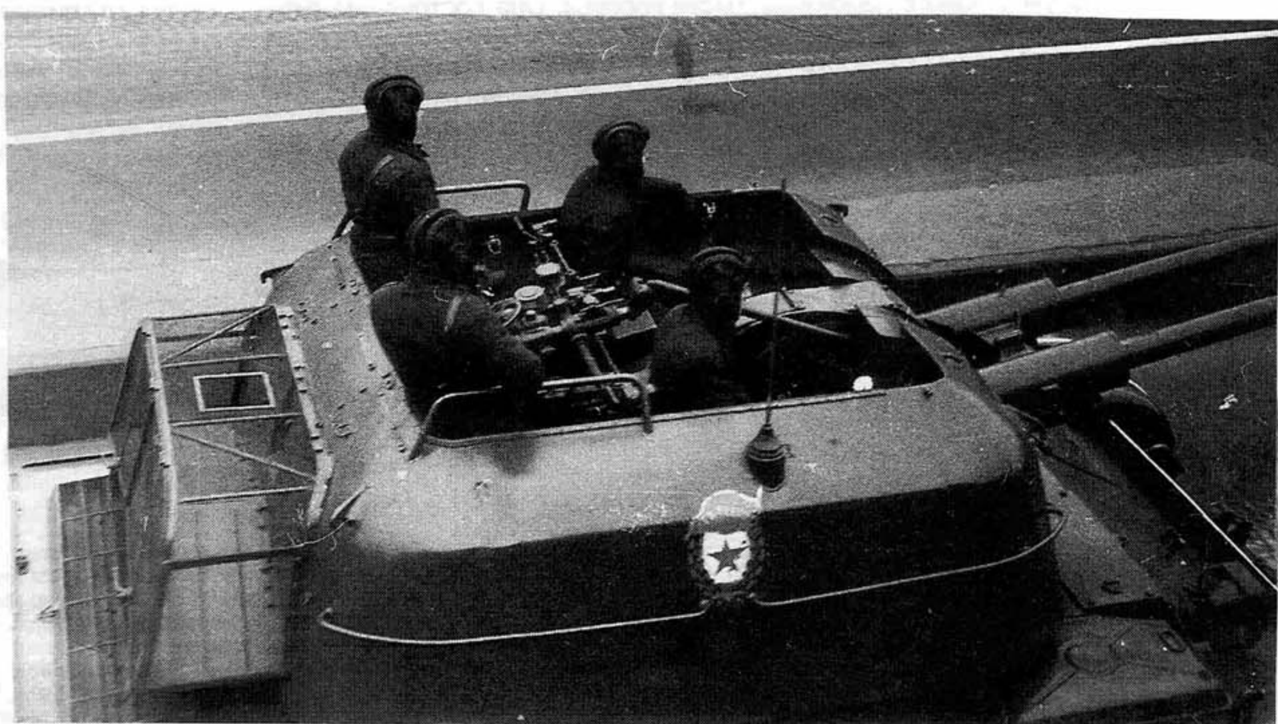
Башня ЗСУ-57-2. На правом наклонном листе — стакан антенного ввода и антенна радиостанции 10РТ-26Э, слева и справа на башне — дуги для крепления тента, на кормовом листе — гильзосборник.
