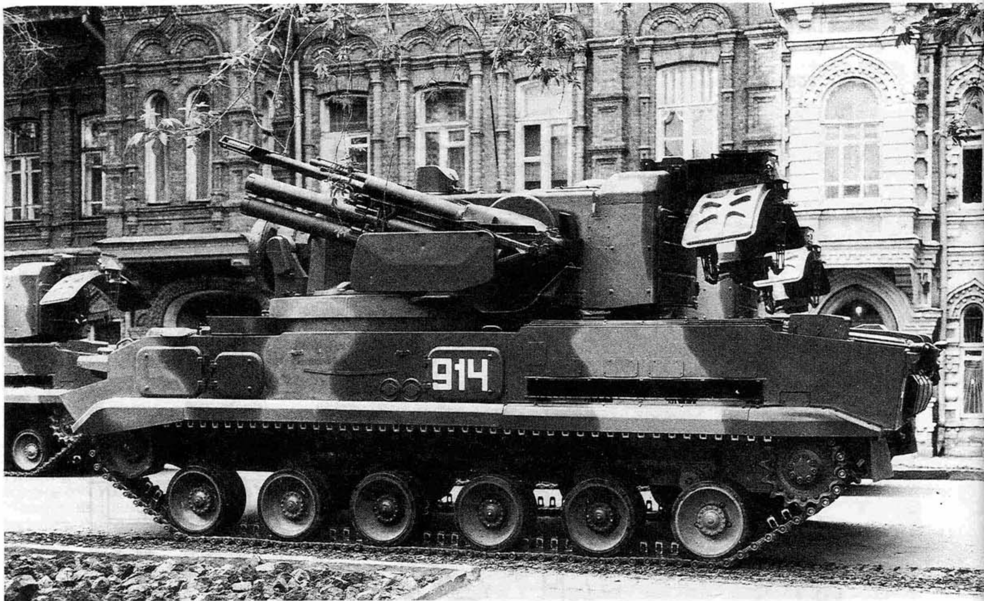
«Тунгуска» перед парадом в Самаре 9 мая 1995 года. Колонка РЛС обнаружения — в положении по-походному, установлены пусковые контейнеры ракет только внешнего ряда.
