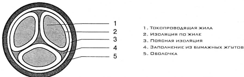
Рисунок 2.2.1-1. Конструкция кабеля марки ААГ с секторными жилами.
