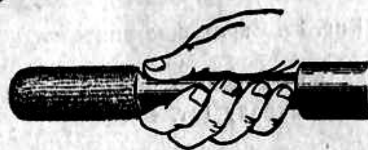
Рис. 29. Как дослать гранату в мортирку ручкой деревянной протирки
