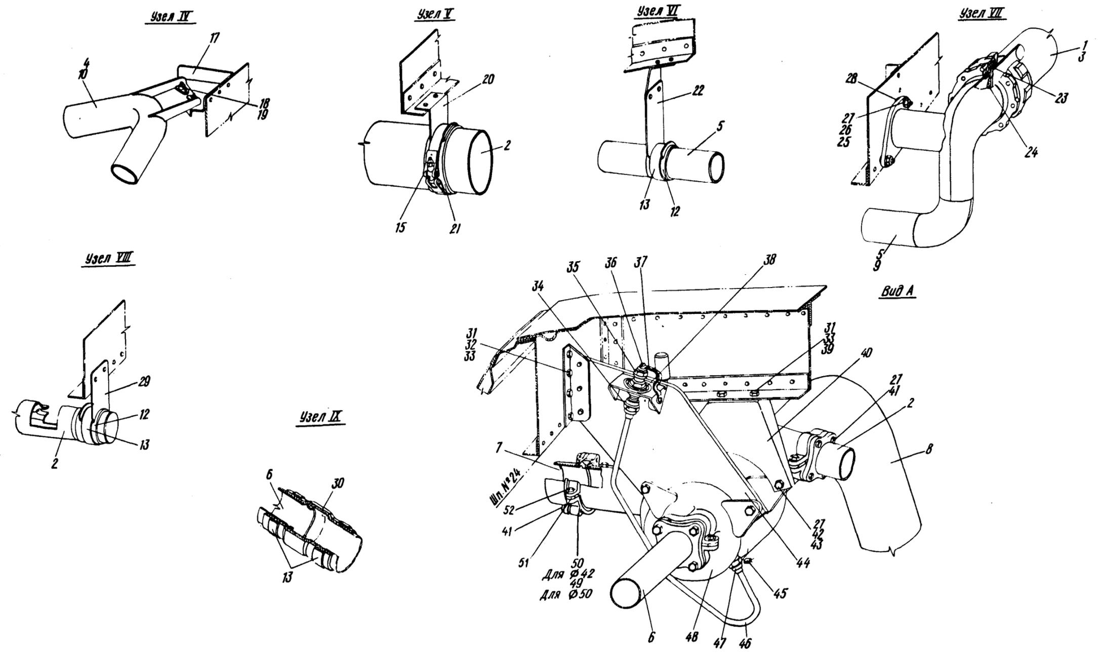
Продув отсека высотного оборудования
