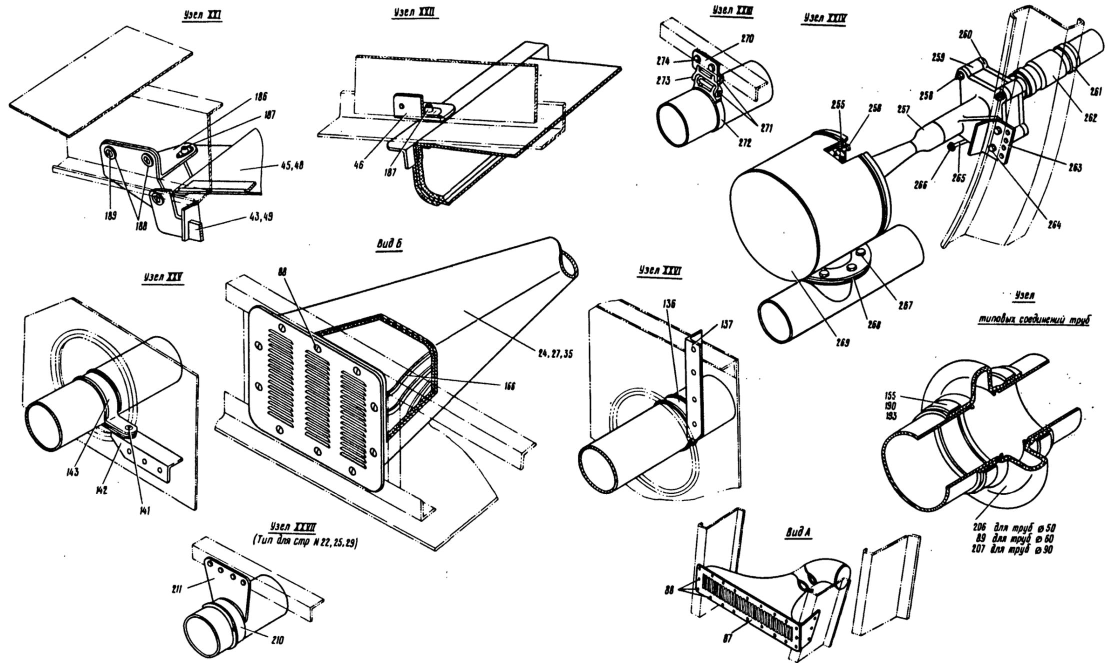
**Монтаж высотного обдува в кабине экипажа
