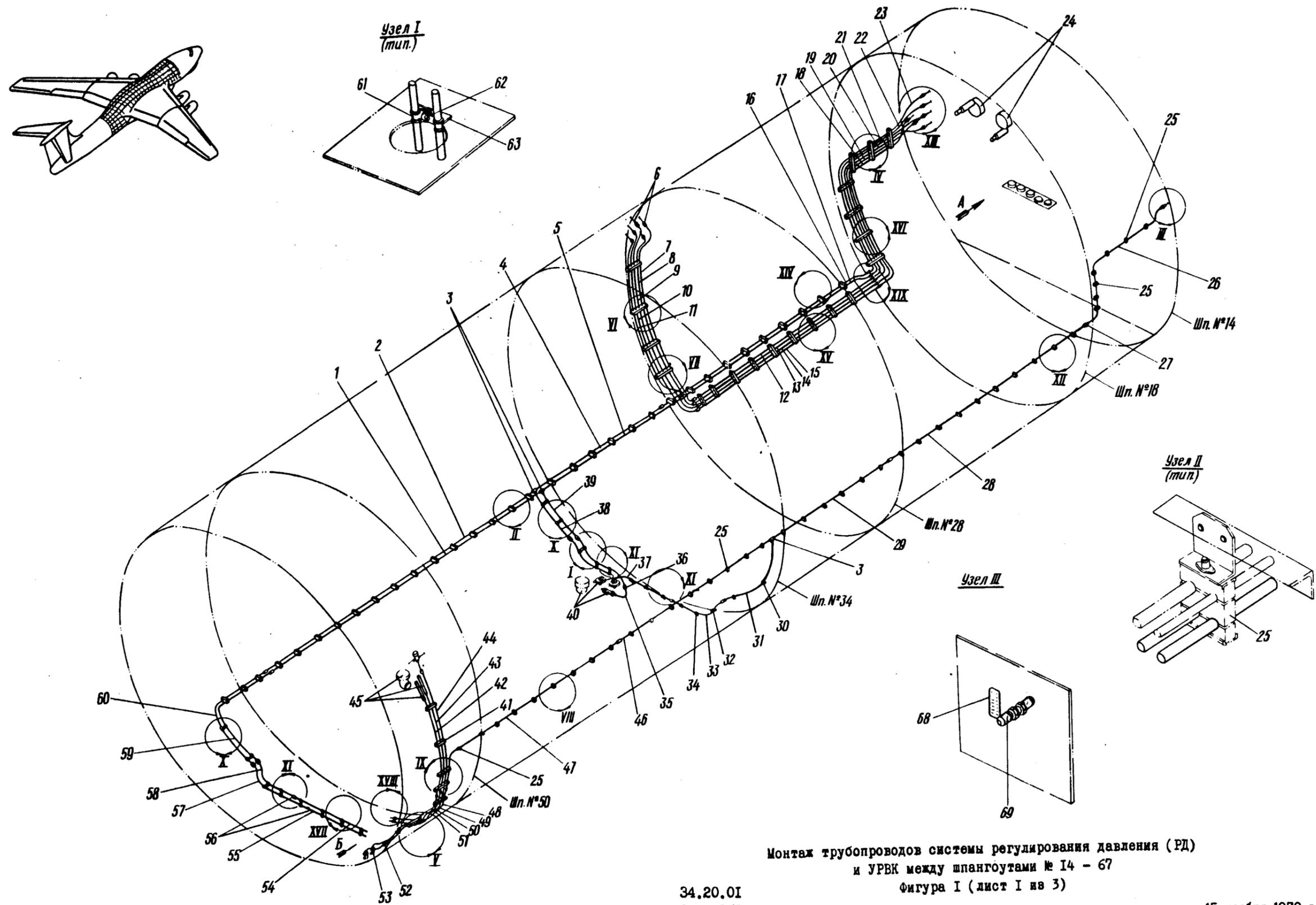
Монтаж трубопроводов системы регулирования давления (РД)
