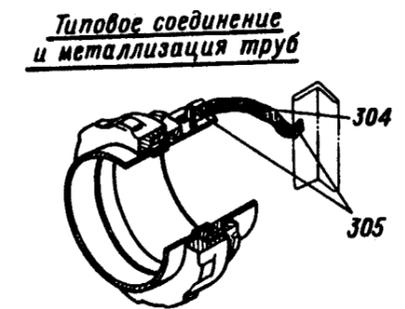
Проводка трубопровода высотной системы
