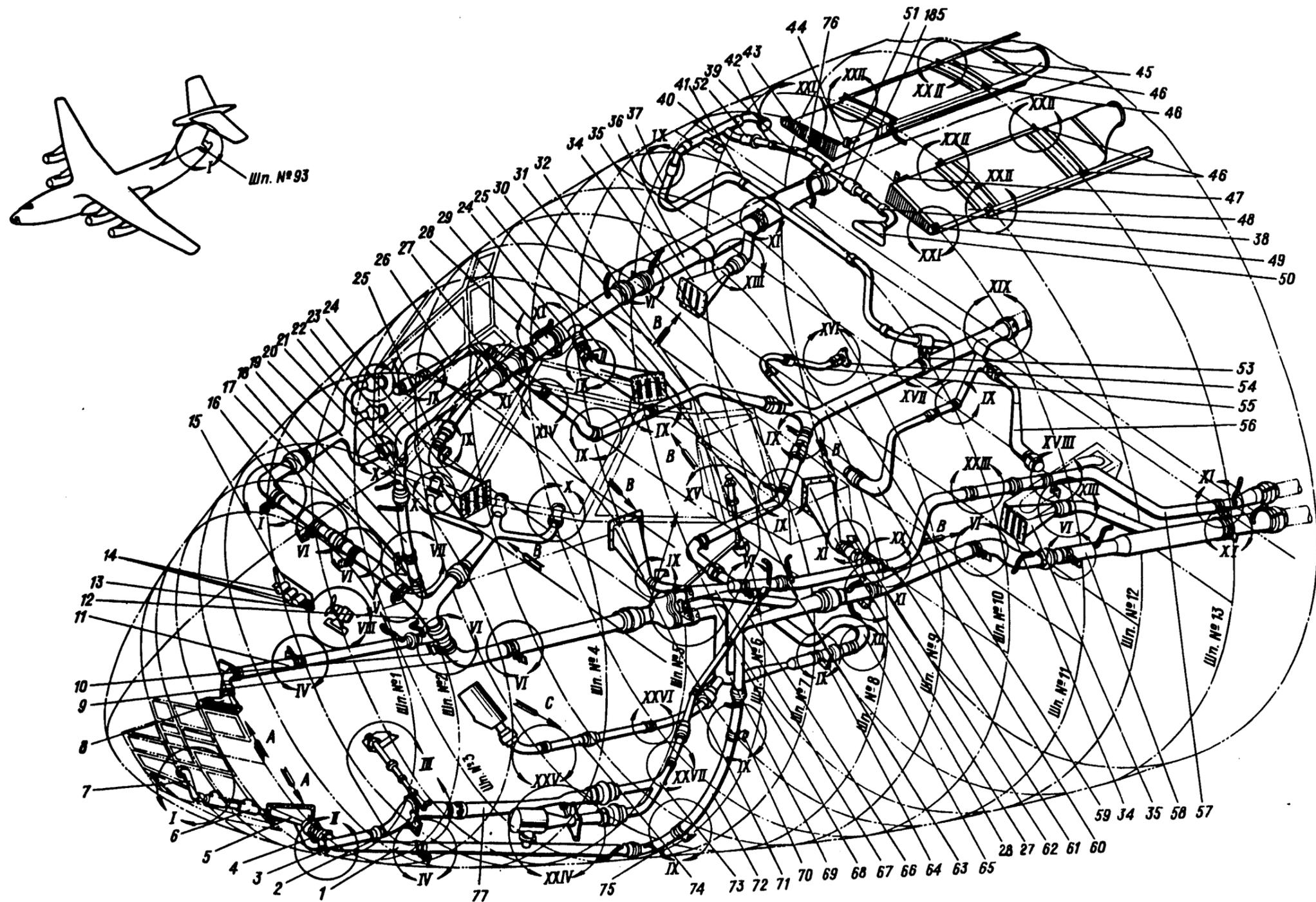
Монтаж высотного обдува в кабине экипажа
