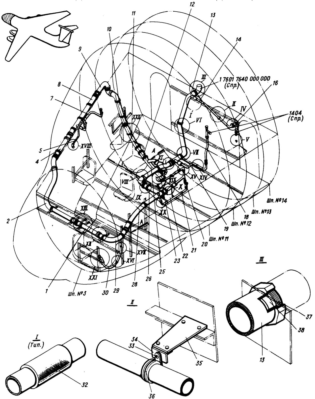
Монтаж трубопроводов вентиляции МСК-3М
