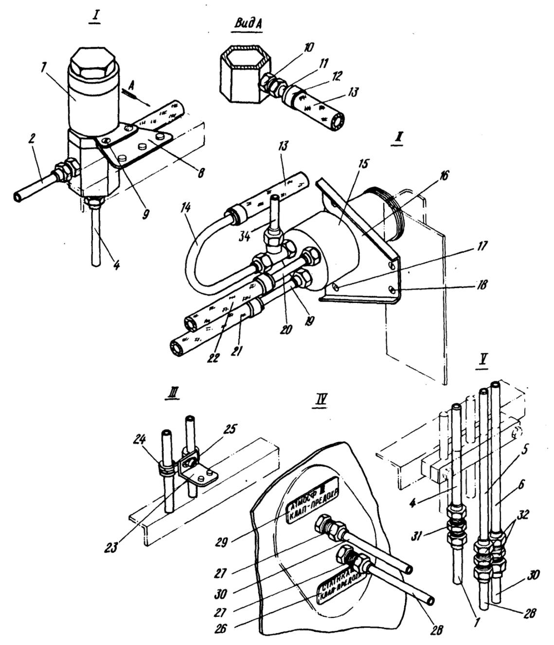
Установка предохранительного клапана
