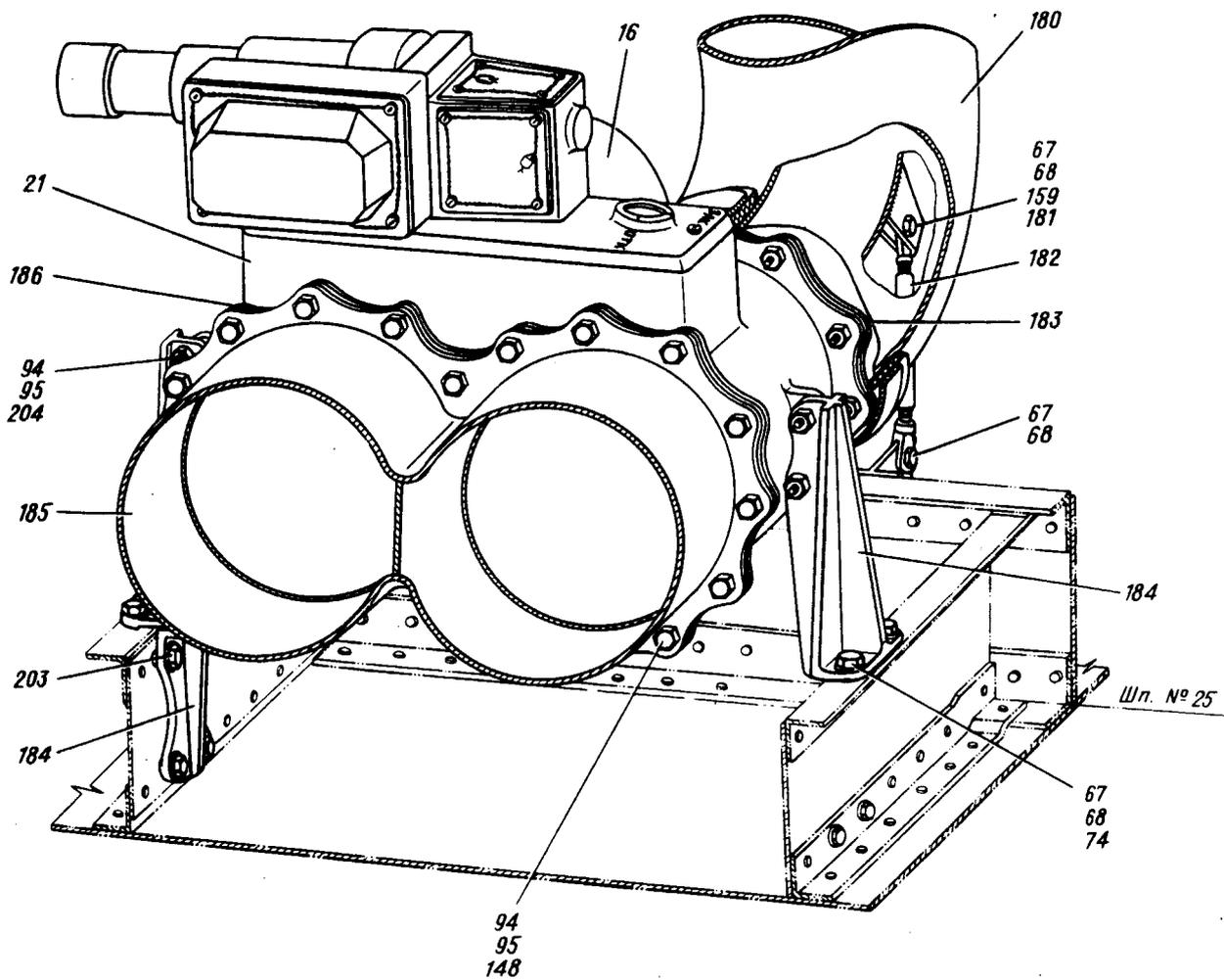
Установка агрегатов в отсеке высотного оборудования
