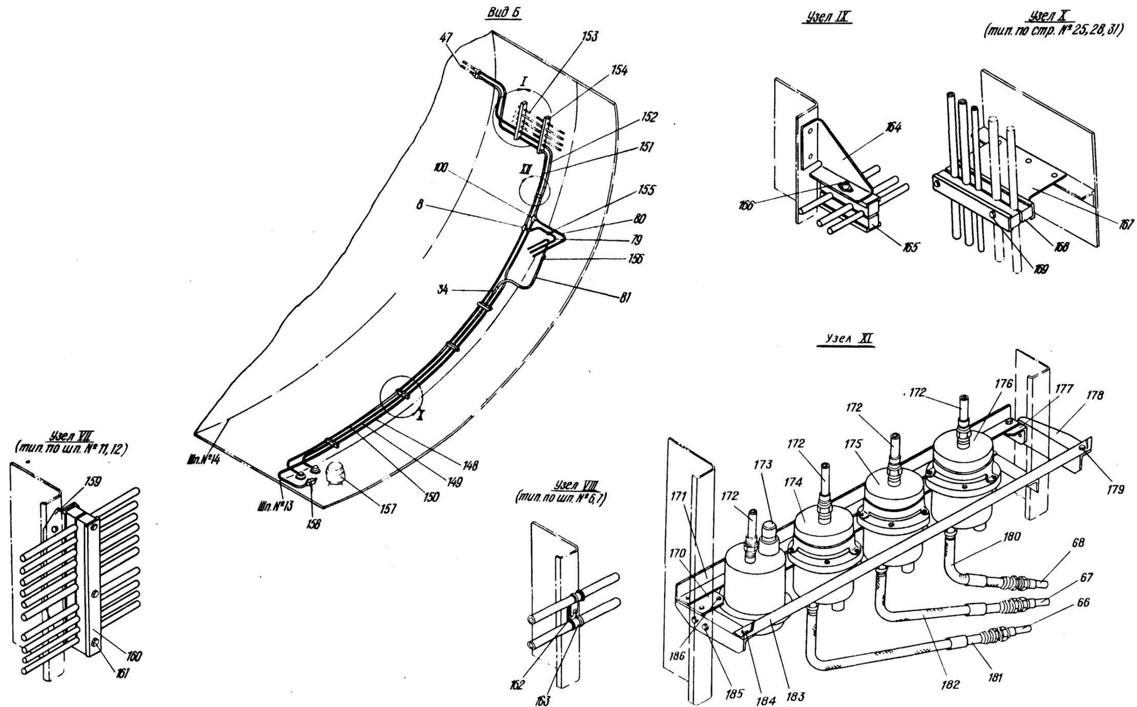
Монтаж трубопроводов системы регулирования давления (РД)
