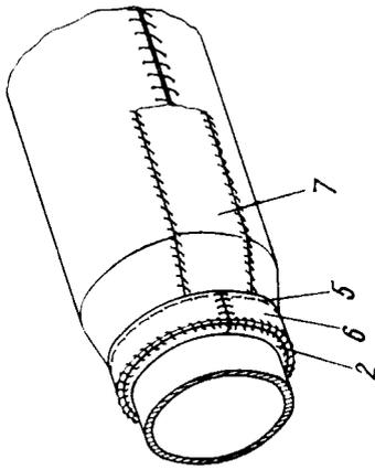
*Типовая установка теплоизоляции на кривых участках трубопроводов*
