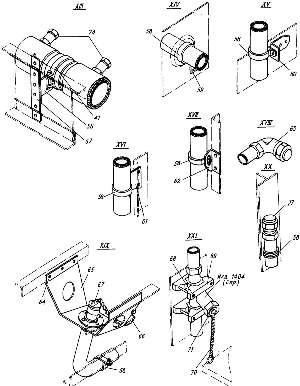
Монтаж трубопроводов вентиляции МСК-3М
