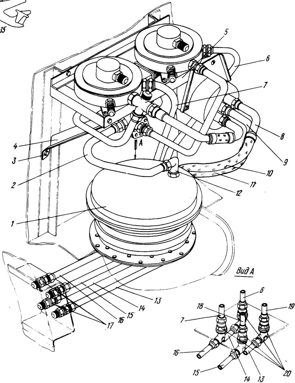
Установка выпускного клапана между шпангоутами № 34, 35
