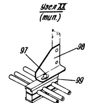
Монтаж трубопроводов системы регулирования давления (РД)
