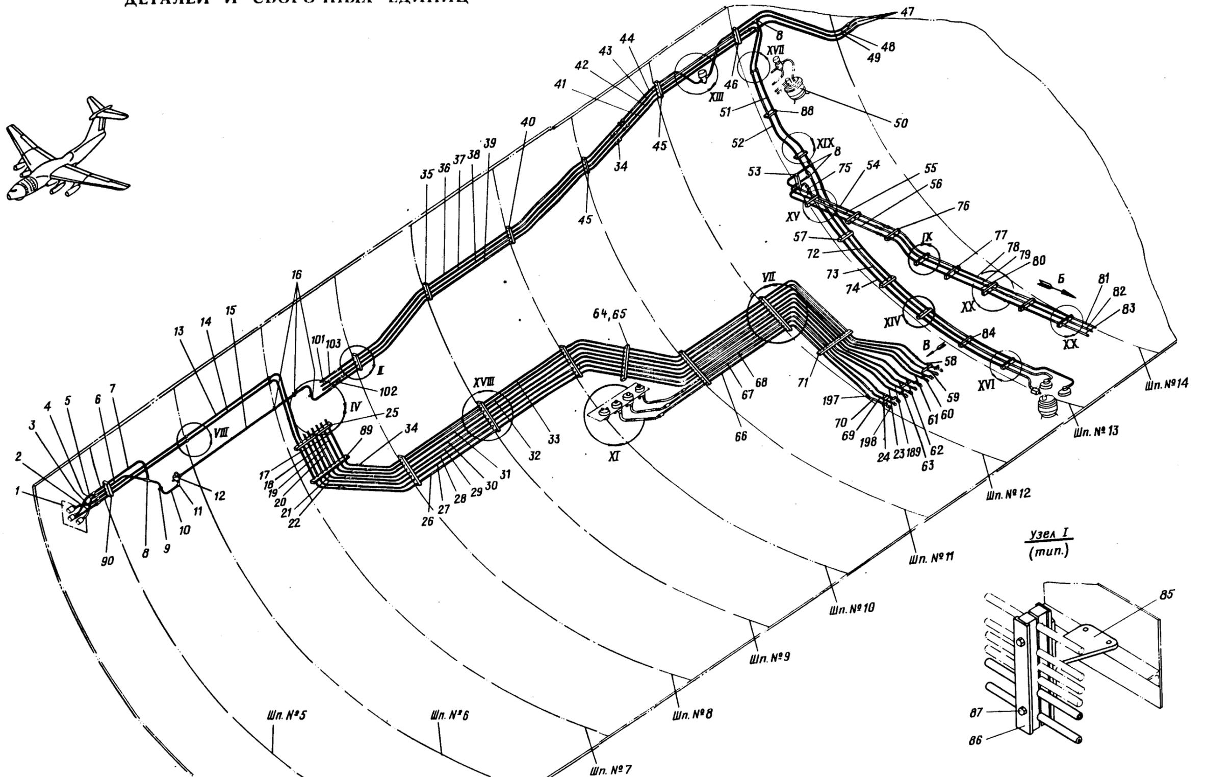
Монтаж трубопроводов системы регулирования давления (РД)
