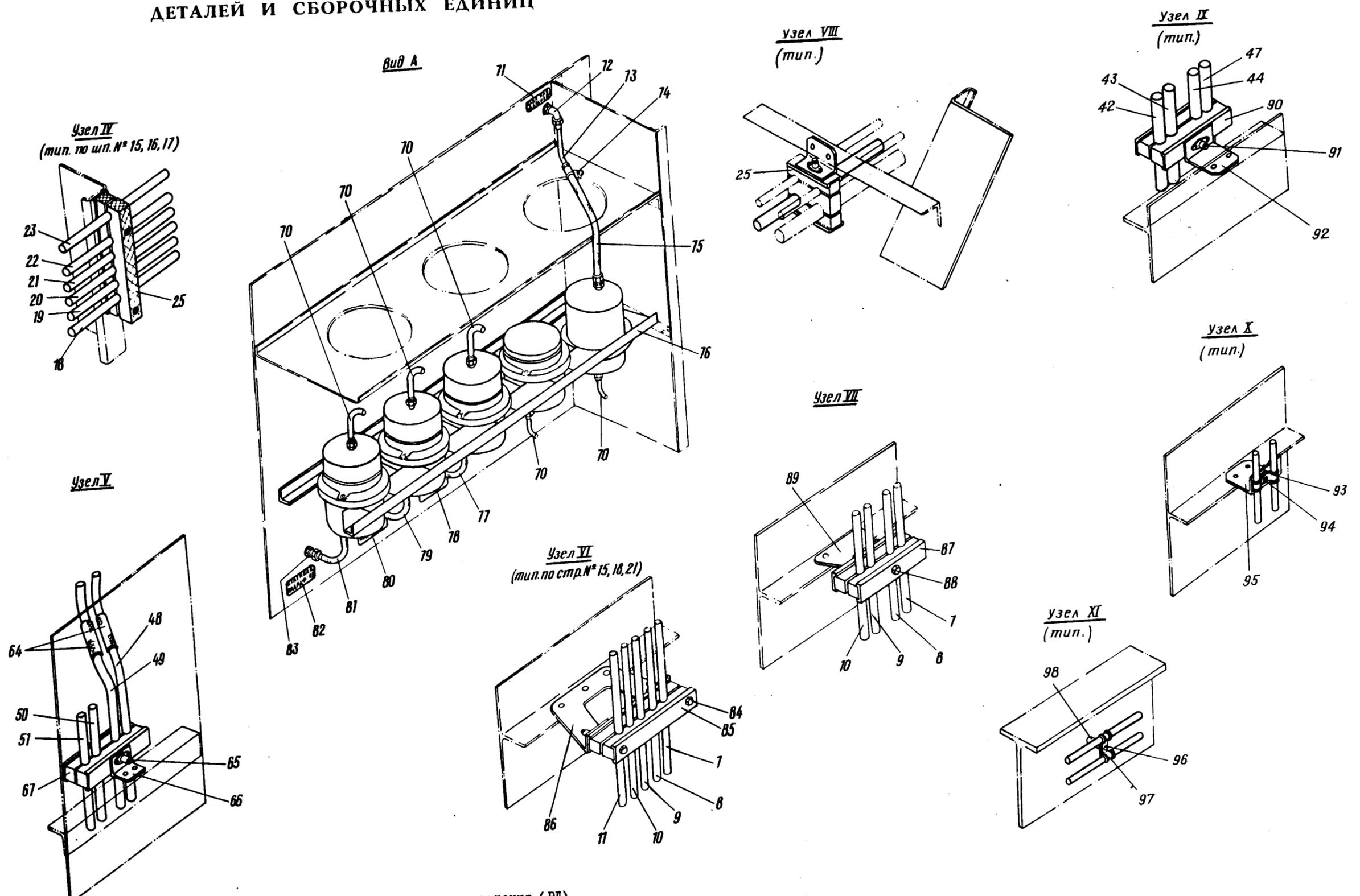
Монтаж трубопроводов системы регулирования давления (РД)
