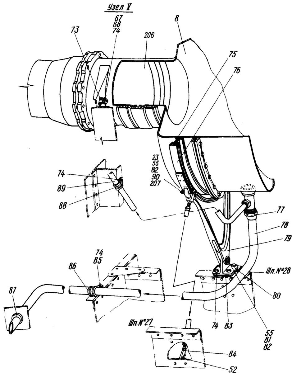
Установка агрегатов в отсеке высотного оборудования
