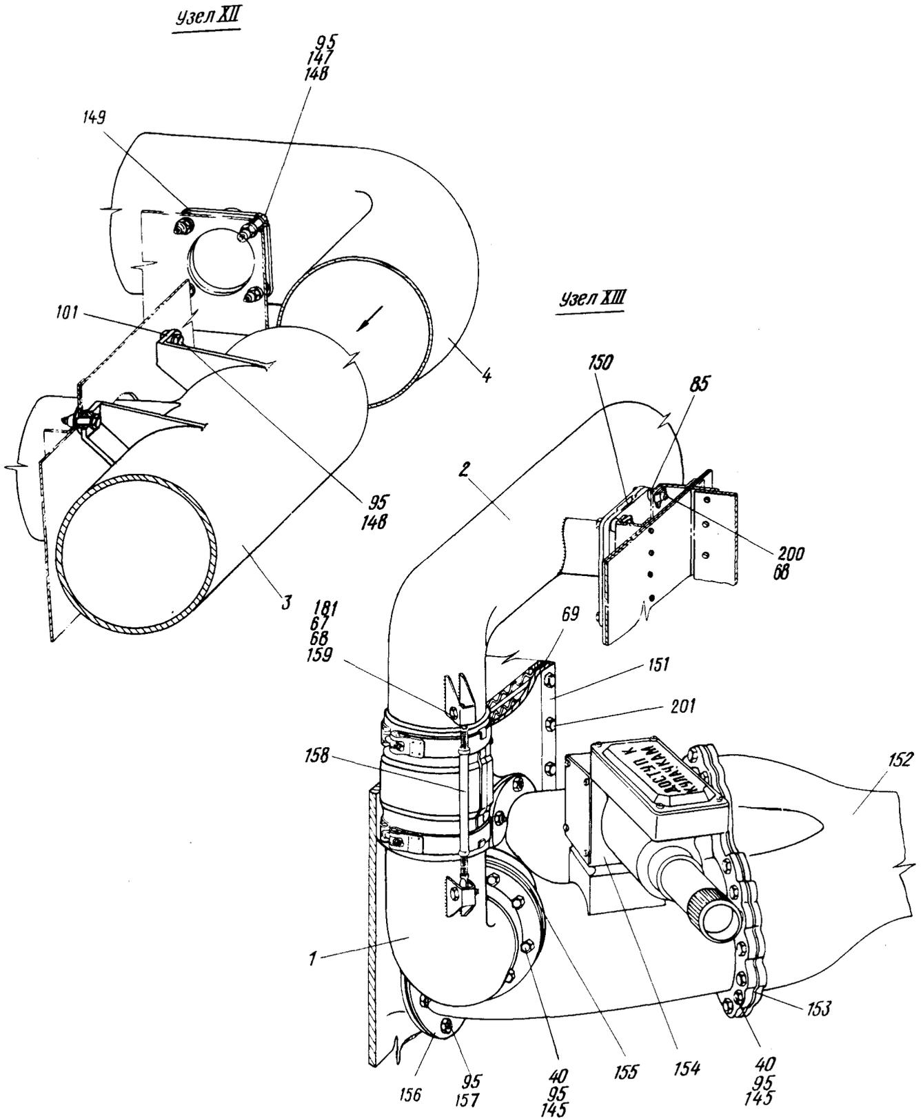
Установка агрегатов в отсеке высотного оборудования
