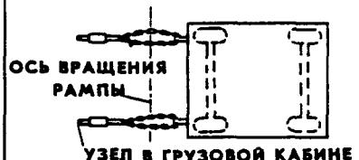
1. ПОГРУЗКУ (ВЫГРУЗКУ) ГУСЕНИЧНОЙ ТЕХНИКИ ПРОИЗВОДИТЬ ПО НАСТИЛАМ УКРЕПЛЕННЫМ НА ПОЛУ ГРУЗОВОЙ КАБИНЫ, РАМПЕ И ПОДТРАПНИКАХ.
