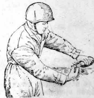
Рис. 103. Вставление хвостового патрона (основного заряда) в трубку стабилизатора 82-мм мины
