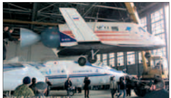
Российская АКС М-55-С-XXI. Вес - 6,3 т. Длина - 7,7 м. Размах крыльев - 5,58 м. Максимальная высота полета - 101 км. Скорость - 5200 км/ч (4,3 Маха). Перегрузки - до 4,5 g
