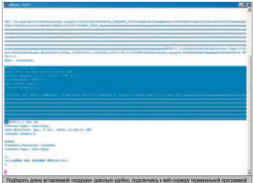
Подбирать длину вставляемой «подушки» довольно удобно, подключаясь к web-серверу терминальной программой
