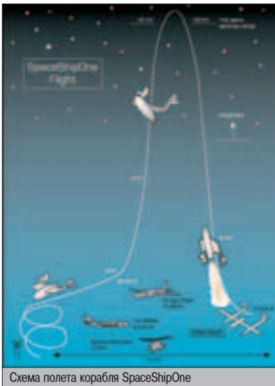
Схема полета корабля SpaceShipOne
