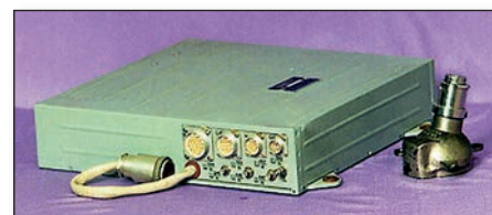
Система «Кактус»: передатчик (справа) и приемник.
