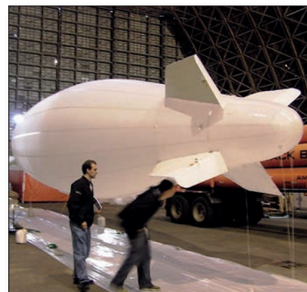
Экспериментальный образец аэростата для будущей миссии к Титану, разработанный Лабораторией реактивного движения (Jet Propulsion Laboratory, NASA) и сконструированный фирмой Near Space Corp. , внутри специального испытательного ангара.
