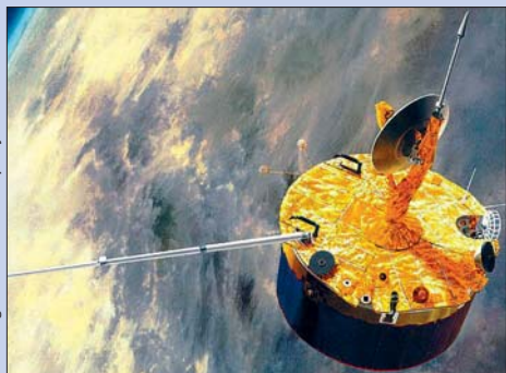
4 декабря 1978 г. Pioneer-Venus-1 перешел на эллиптическую орбиту вокруг Венеры. Диаметр станции 2,5 м, высота — 1,2 м.
