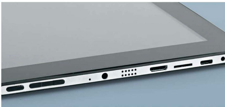
Основные органы управления и кардридер microSD выведены на левую сторону, все рядом. Но фирменный чехол затрудняет доступ к ним и отверстиям динамика
