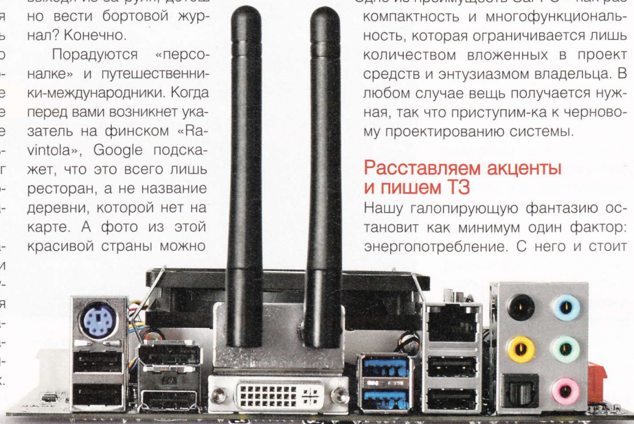
Матплата ZOTAC D2700-ITX WIFI SUPREME оснащена всем необходимым, включая Bluetooth
