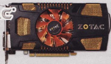
Эта видеокарта привлекает внимание своей способностью поддерживать вывод изображения сразу на три монитора с разрешением Full HD. Она оснащена тремя видеовыходами – Dual-link DVI / DisplayPort и парой портов HDMI. (1 шт.)
