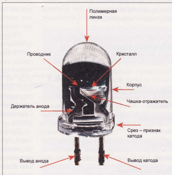
Все светодиоды малой мощности устроены примерно одинаково. Цвет определяется свойствами кристалла
