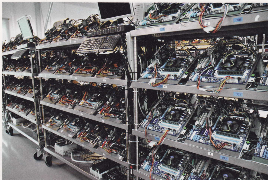
Компьютеры тестовой лаборатории в действии. Сейчас они проверяют на работоспособность планки памяти объемом 2 Гбайт. Часть из них через 10 минут отправится в ремонт
