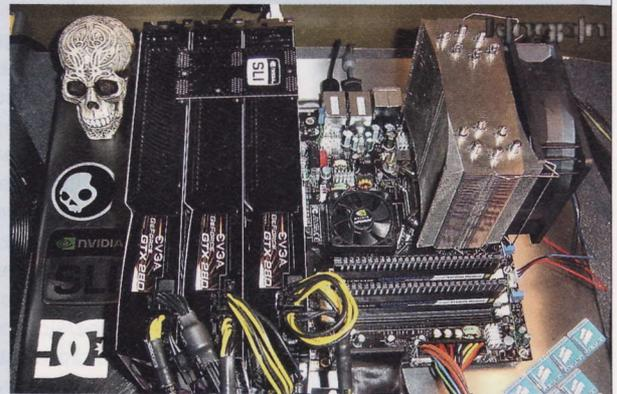
ключениями из этого правила являются тяжелые SLI- или CrossFireX-системы, состоящие из трех и более видеокарт, которые непременно должны иметь достаточную производительность. Но и для этих монструозных конструкций зачастую определяющим фактором является скорость работы центрального процессора, а не пропускная способность интерфейса PCIe.
