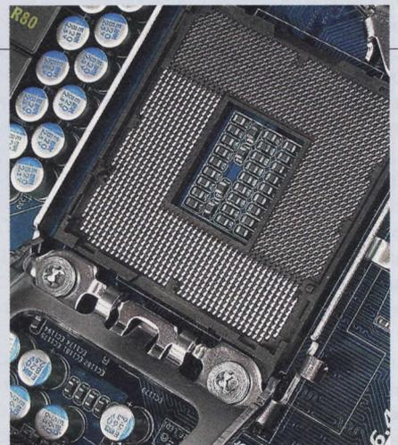
Крепеж кулеров Thermalright позволяет регулировать силу прижима в диапазоне от 40 до 70 фунтов. Допустимая нагрузка со стороны системы охлаждения на современные процессоры Intel составляет как раз 70 фунтов (в метрической системе это примерно 32 кг).
