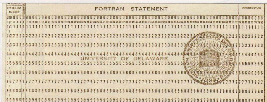
В перфокартах пробивались необходимые отверстия, и оптическая система считывала данные
