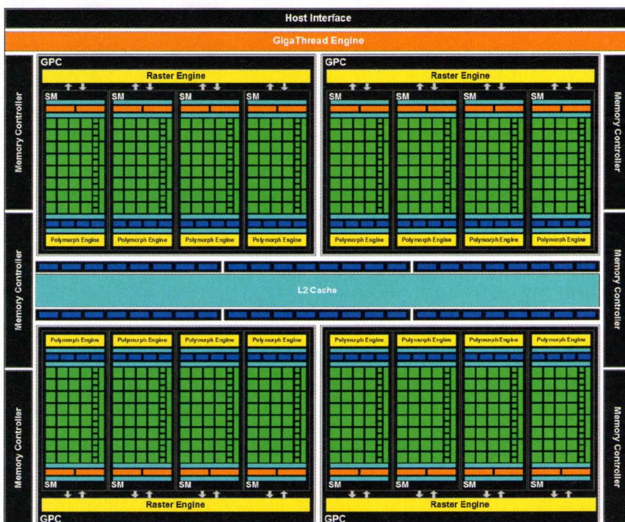
Блок-схема видеочипа GF 110. За исключением мелких доработок, полная аналогия GF 100
