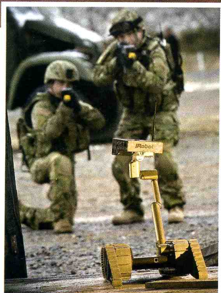
Скромный трудяга SUGV может преодолевать препятствия полуметровой высоты и проводить разведку вместо человека
