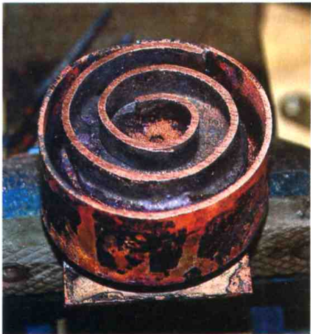
Самодельный испаритель в процессе изготовления (впоследствии вместо него был использован литой вариант). Хорошо видно количество окалины, возникающей при пайке
