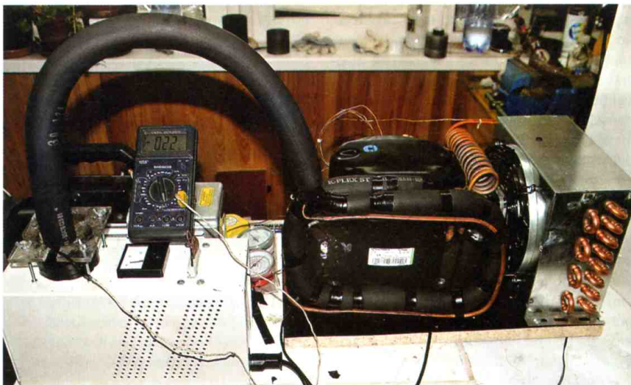
Готовая система испытывается под нагрузкой 300 Вт. Столько тепла выделяет сильно разогретый четырехъядерник, работающий под напряжением, составляющим 120-140% от номинала
