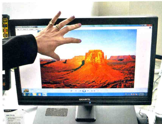
Монитор, в котором использована технология Multitouch. Изображения на экране можно увеличивать и уменьшать двумя пальцами
