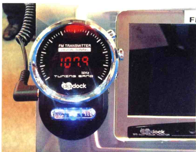
Это автомобильный трансмиттер, к нему надо подключить MP3-плеер, затем настроить частоту, и радио в машине будет играть вашу музыку
