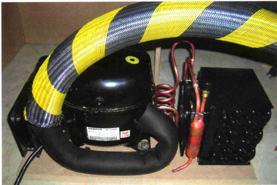
Вот пример качественной самодельной фреонки. Желтый кружок на компрессоре Embraco Aspera означает, что в нем используется синтетическое масло, совместимое с большинством фреонов
