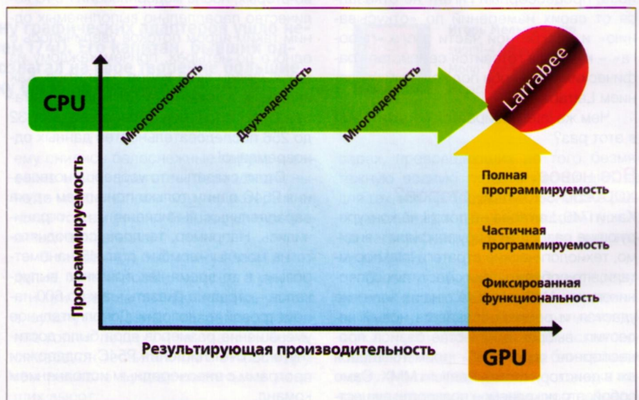
Официальная схема Intel, демонстрирующая пути развития процессоров и видеокарт. Как видно из нее, инженеры компании спроектировали некую смесь из GPU и CPU
