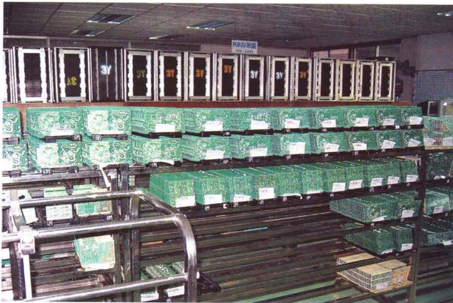
Именно так выглядит промежуточный склад печатных плат, которые затем устанавливаются в блоки питания, продающиеся как под брендом FSP, так и под лейблами других компаний
