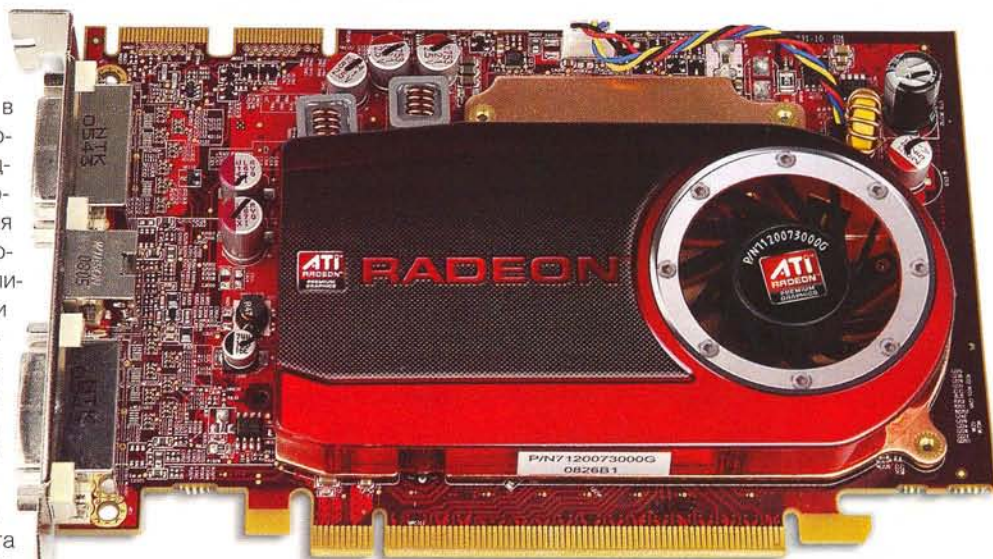
ATI RADEON RHD4670. К сожалению, однослотовое референсное охлаждение не может обеспечить приемлемую температуру ядра. Да и шумит сие творение весьма ощутимо
