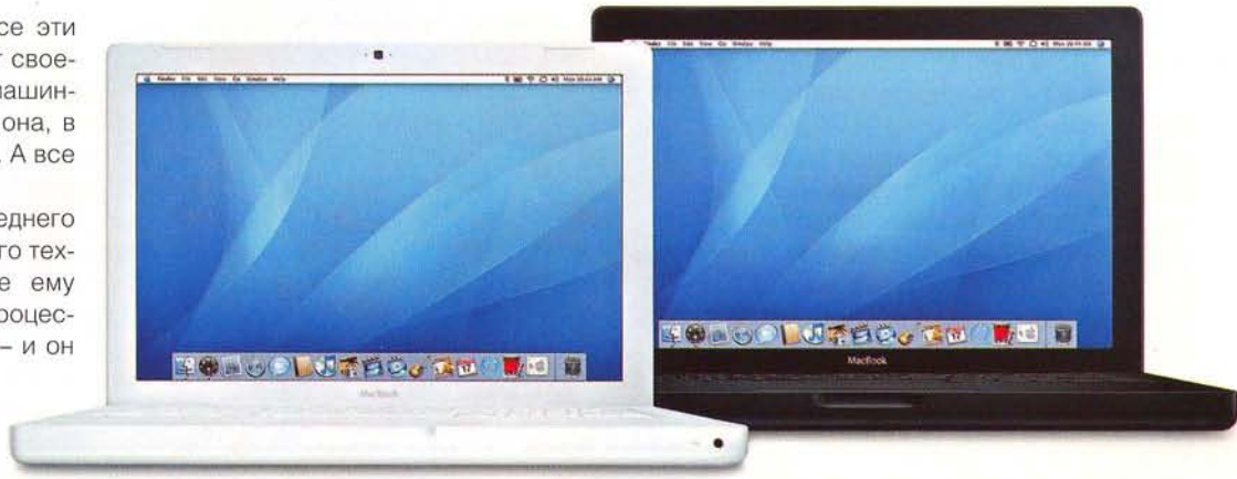
Это последний «яблочный» ноут, сделанный из поликарбоната, а не из алюминия. Начинка на данный момент унифицирована: гигабайт оперативки, Core 2 Duo (2,1 ГГц), графика Intel X3100, DVD-резак
