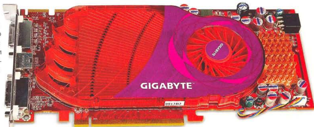
GIGABYTE GV-R485-512H-B (ATI RADEON HD4850). Однослойное решение, красный кулер с мелкой турбиной... Ничего не напоминает? Ага, еще на 1950 Pro такие ставили
