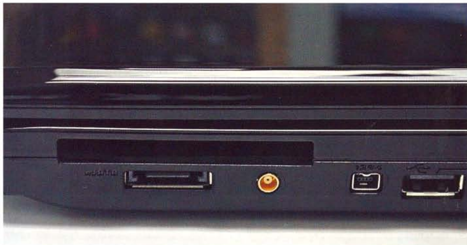
eSATA – мобильная версия SATA, предназначена для подключения внешних накопителей
