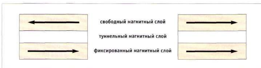
Рис. 1. Магнитные слои, составляющие битовую ячейку MRAM
