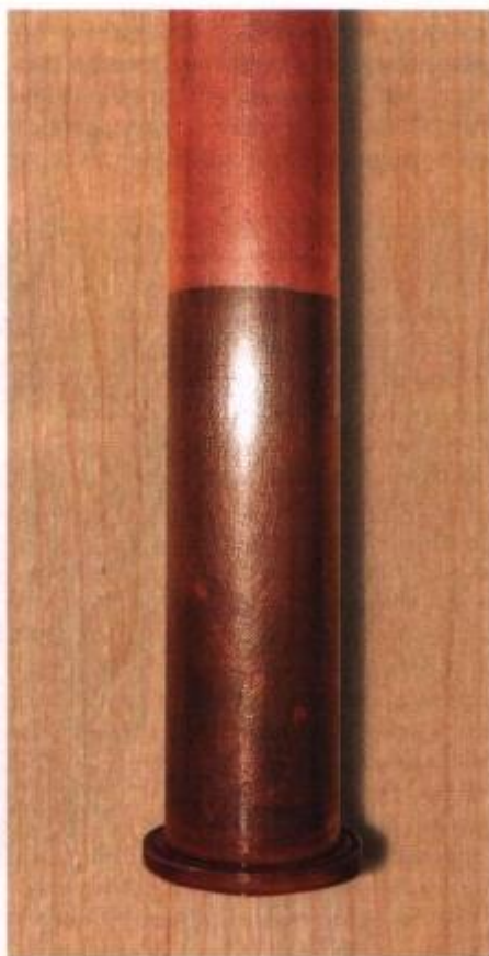
Нижняя часть стакана очищена механическими способами, верхняя погружена на три часа в «Фанту»: «Пей Fanta – будь бамбуча!»
