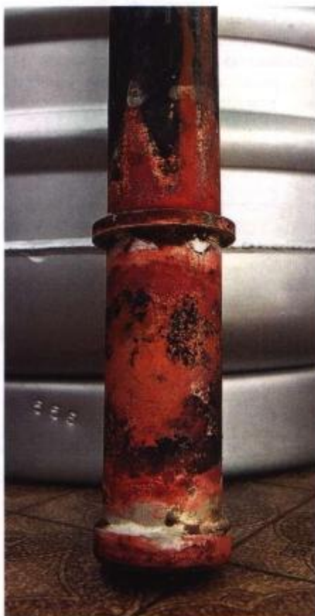
Вот в таком ужасающем виде стакан пришел ко мне с завода. Газовая горелка и припой сделали свое грязное дело
