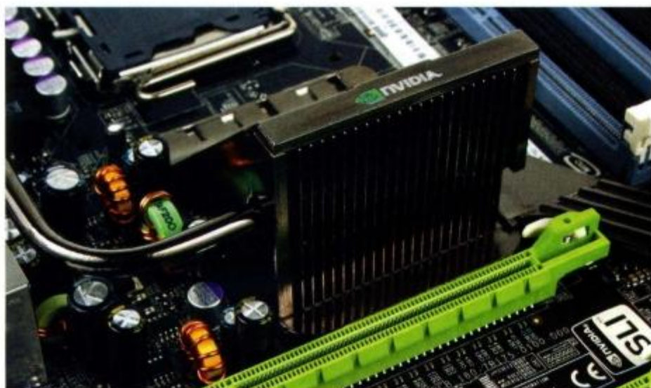
Взгляните на систему охлаждения – ее можно воспевать в фантастических романах. Никаких медных «американских горок», исключительно строгий анодированный алюминий
