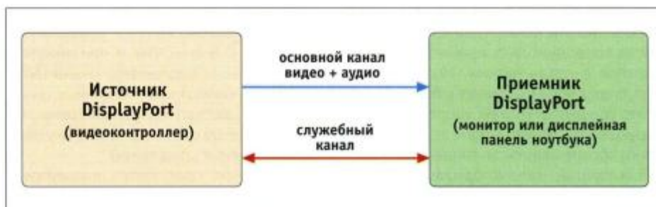
Блок-схема, демонстрирующая обмен данными при использовании интерфейса DisplayPort
