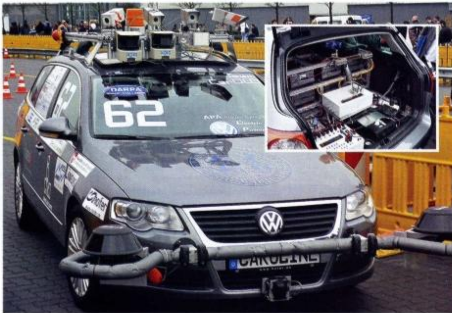
Данный автомобиль в состоянии передвигаться без водителя и при этом достаточно уверенно объезжать препятствия. Куча электроники и проводов в багажнике – это его мозги
