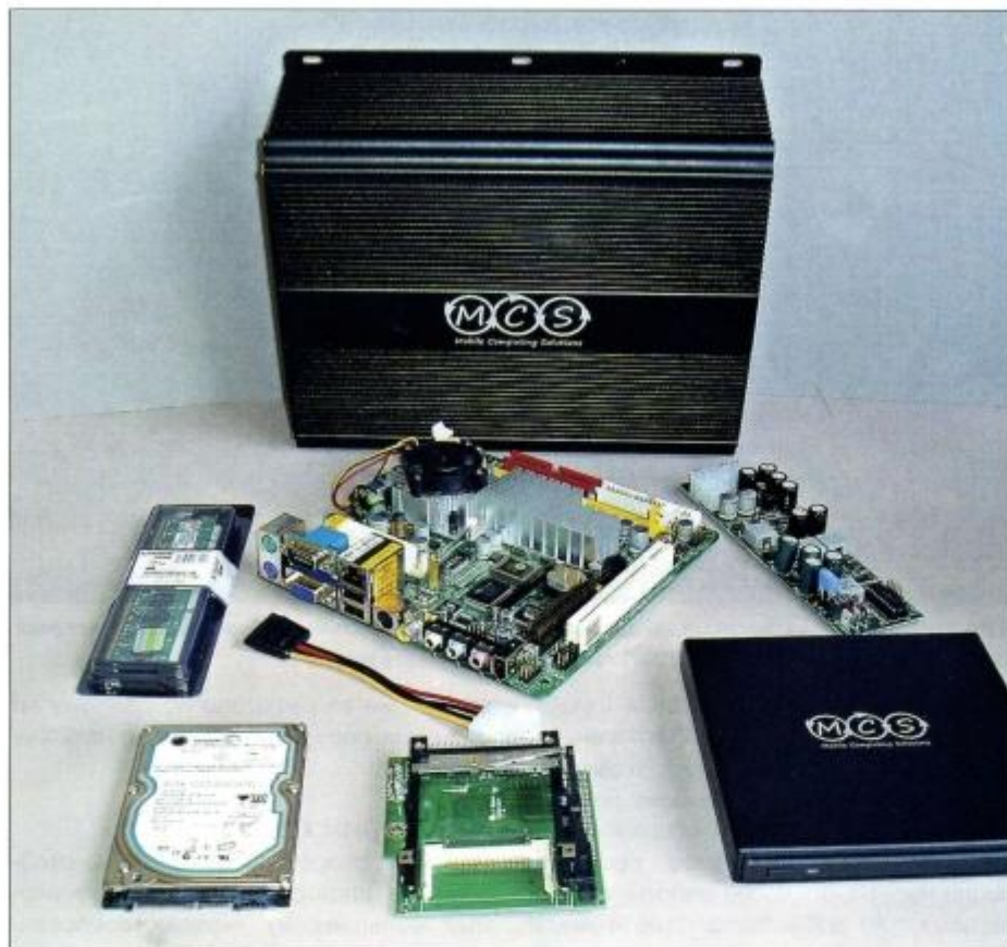
Типовой наборчик, требующийся для создания автомобильного ПК из обычных комплектующих: компактный кузов, mini-ITX-мать с CPU, ноутбучные память, винт и привод, а также БП на 12 В
