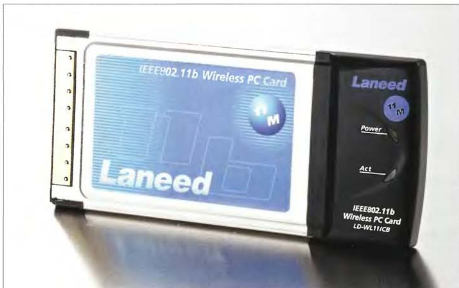
Ноутбучная Wi-Fi-карта, втыкаемая в PCMCIA-слот и расширяющая функциональность старых ПК
