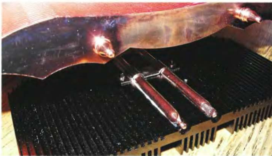
Грамотный пассивный кулер: трубки смазаны термопастой и плотно привинчены к радиатору
