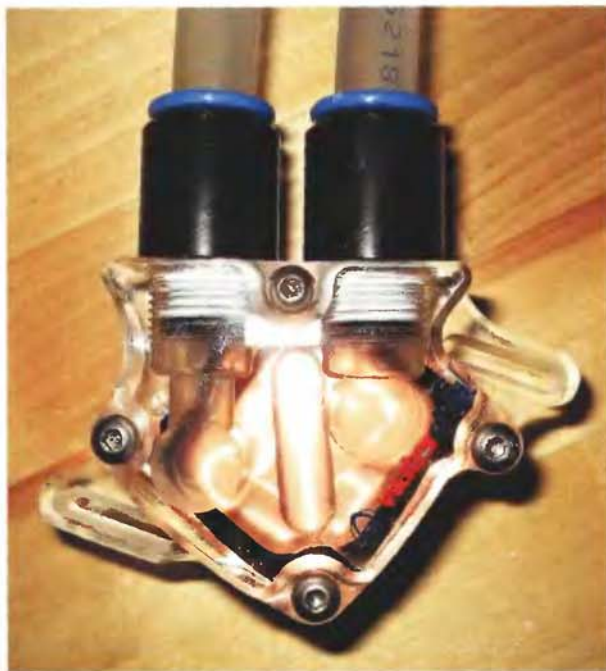
Ватерблок для видеокарты производства именной WaroChill. Просто, красиво, дорого. В меру эффективно
