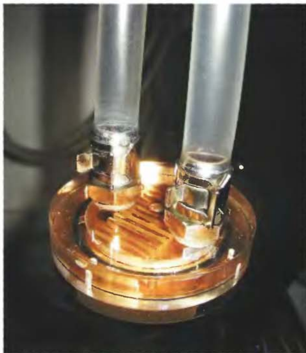
Процессорный ватерблок совсем неизвестного производителя. Снова классика жанра – «плексиглас на меди»
