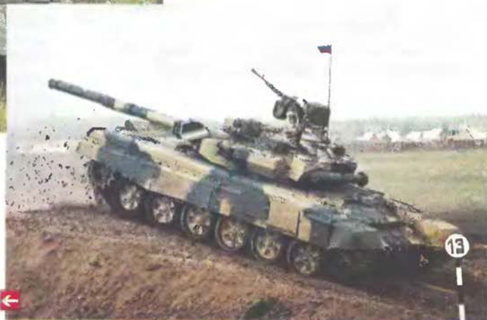
Высокоточное оружие позволяет легко модернизировать и относительно старые образцы оружия. Новая электроника, навесная динамическая броня третьего поколения – и старенький Т-72 снова в строю!
