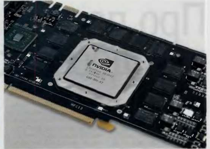
8800GTX без кулера. Видны GPU, видеопамять и RAMDAC
