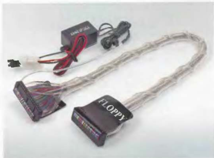
Интерфейсный кабель для FDD от компании Mitron. Выглядит впечатляюще, но все же не настолько, чтобы ради него ставить в корпус дисковод.
