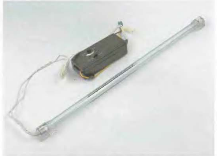
Флуоресцентная лампа Mitron Dream Machine Cold Cathode Light Kit. Если не поленились убрать провода в красивую оплетку, получится еще лучше.
