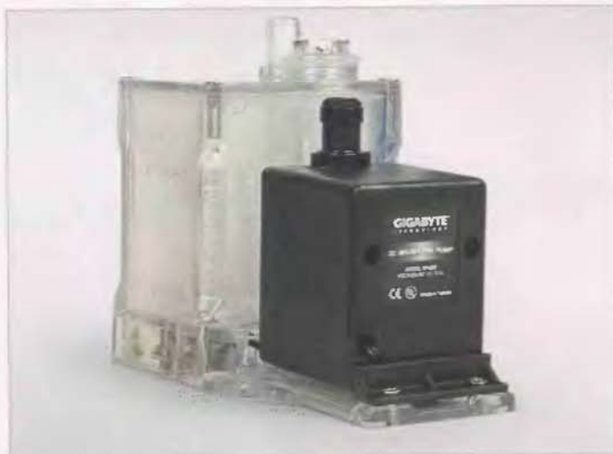
Помпа соединена с бачком, установленным на пластиковом основании.
