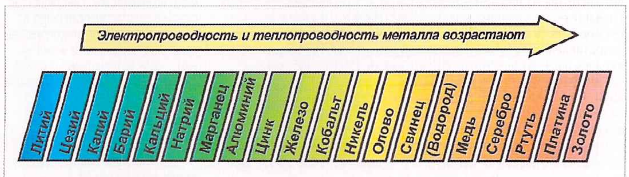
Электрохимический ряд металлов. Способность металла вступать в реакции уменьшается слева направо.
