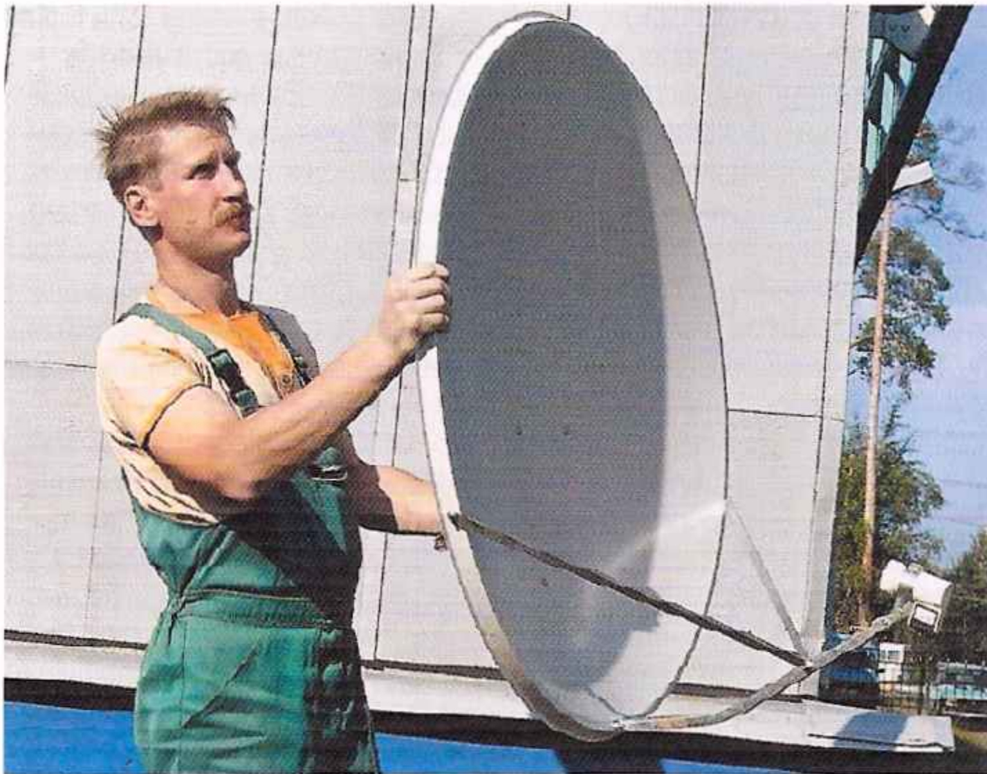
В отличие от конвертеров прямофокусных антенн, конвертер офсетной не загромождаёт самого зеркала.
