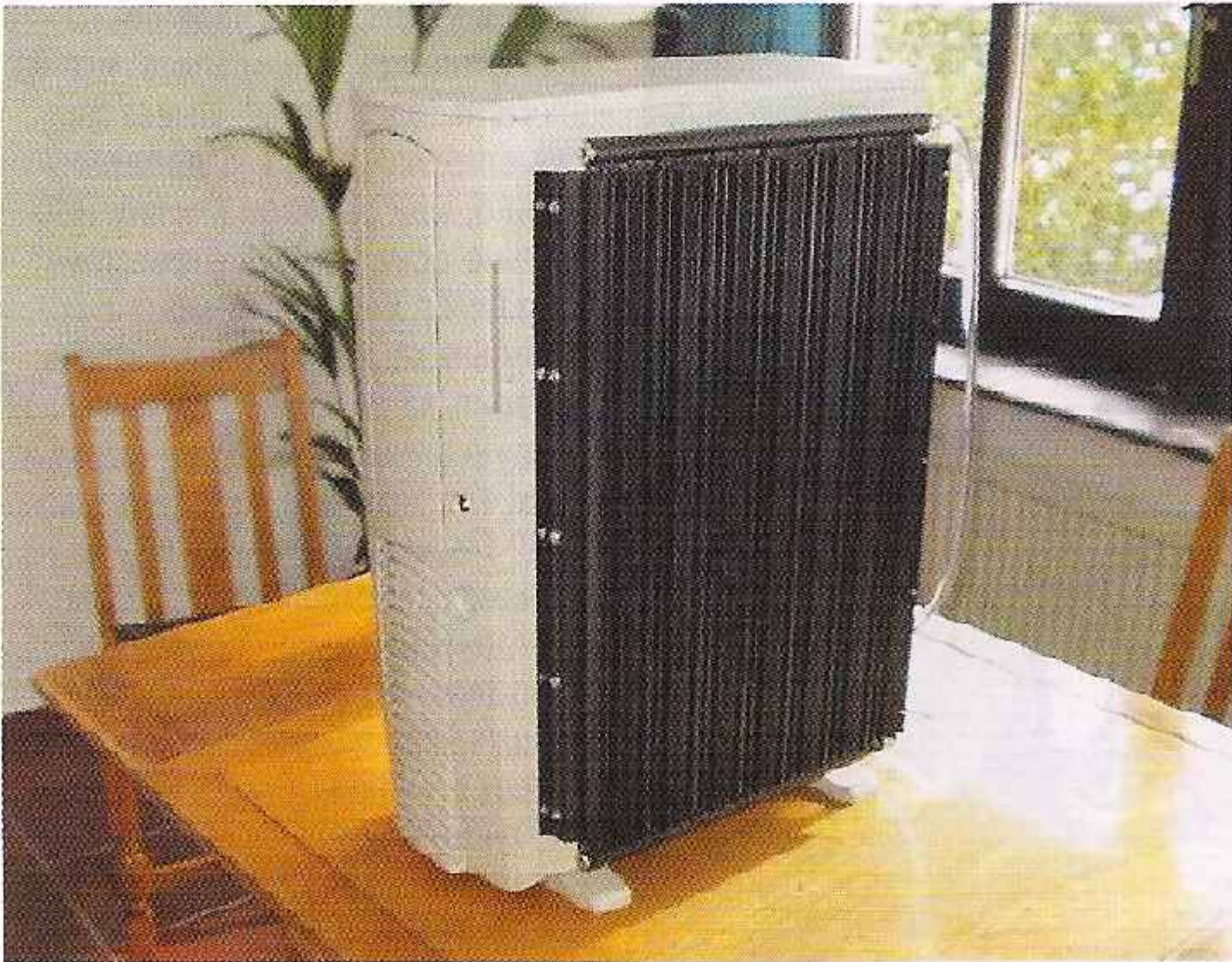
Радиаторы можно монтировать даже на стенках корпуса. Их площадь позволяет установить какое угодно количество ребер.
