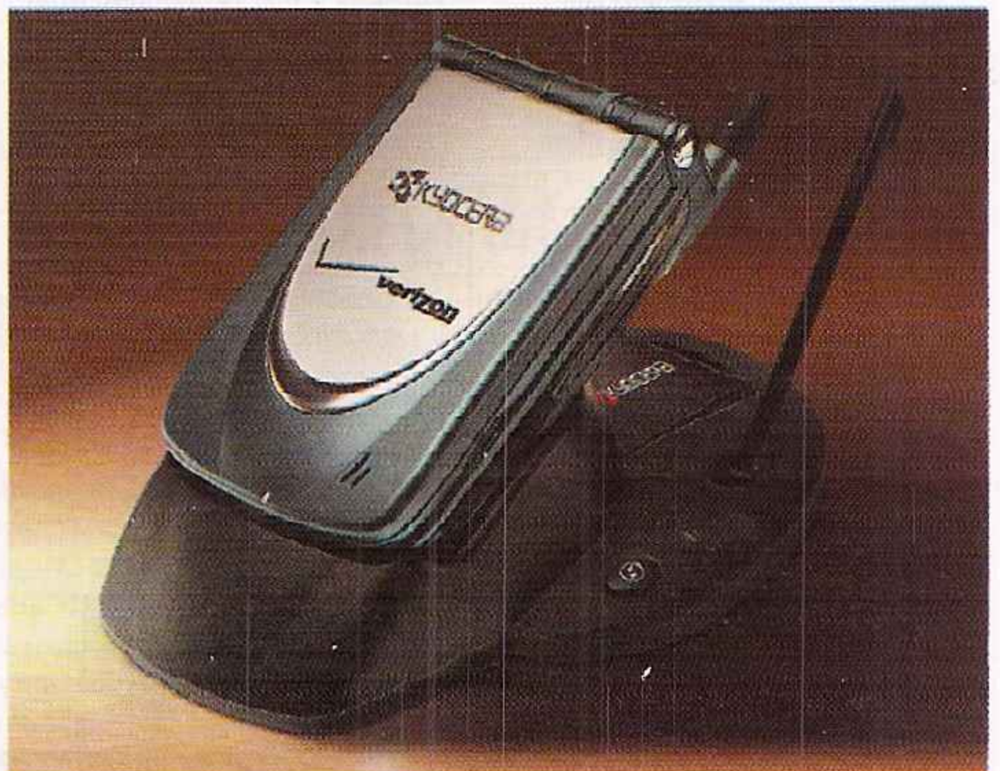
Kyocera 7135 - сотовая трубка на Palm OS 4.1. Корпус у нее невелик, но в нем уживаются дисплей, процессор и 16 Мбайт памяти.
