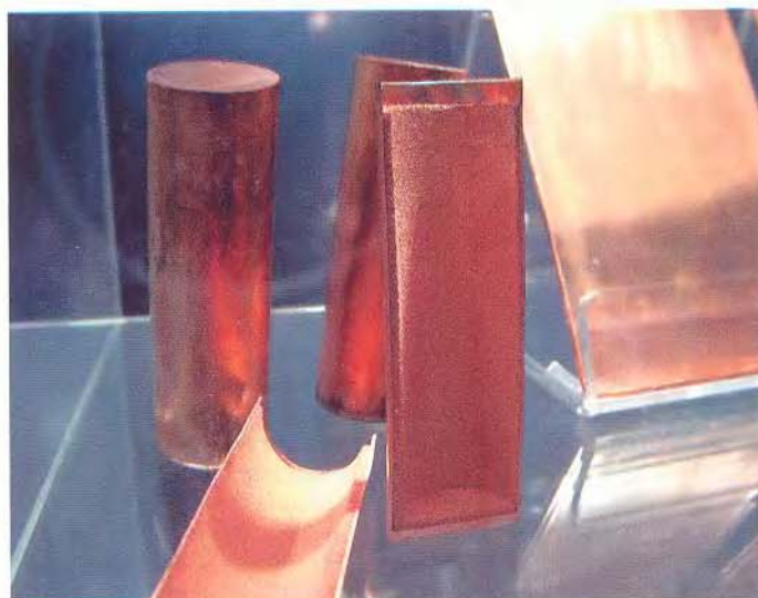
Внутри испарительной трубки, помимо жидкости, есть медное напыление.
