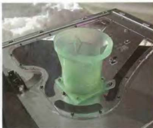
Воздуховод на боковой стенке поможет процессорному кулеру получать извне холодный воздух.
