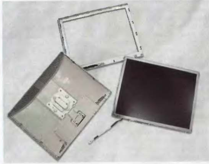
После разборки монитор выглядит так. Корпус и подсветку можно будет продать, а матрица нам понадобится.
