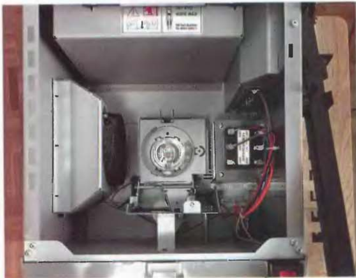
Так выглядят внутренности кодоскопа. Система очень простая: лампочка, проекционный столик, и в "голове" - система линз.
