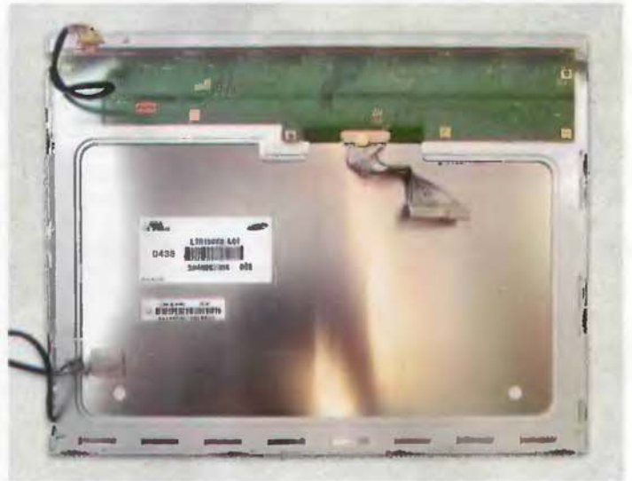
Будьте особенно осторожны как с матрицей, так и со шлейфами, которые соединяют ее с управляющей схемой.
