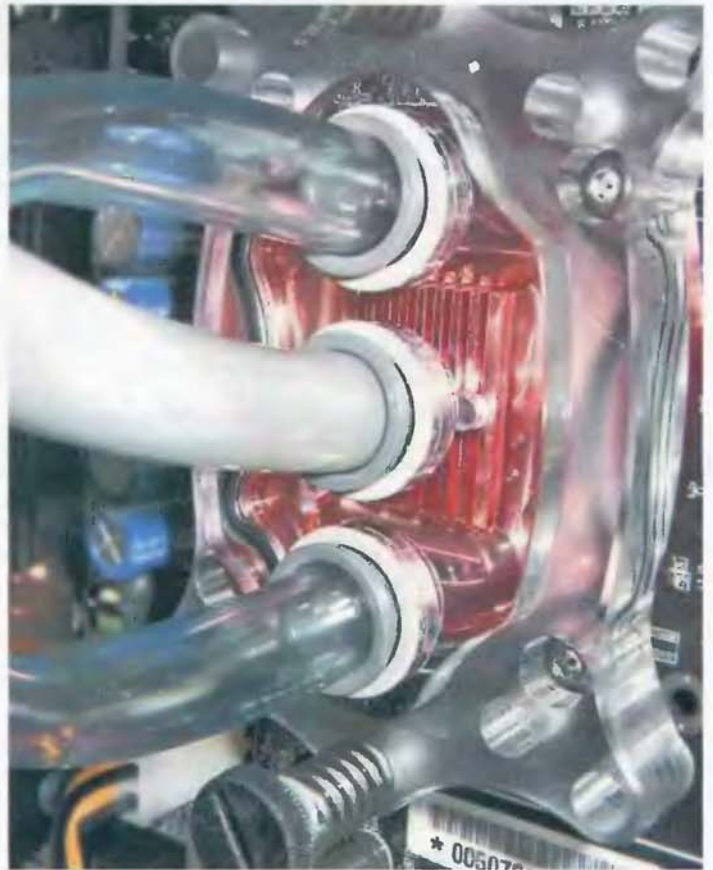
Примерно так выглядит двухлоточный ватерблок с тремя патрубками. Как видите, красивая и эффективная конструкция.
