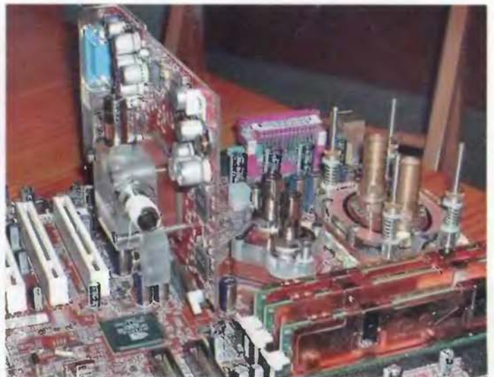
Ватерблоки с прозрачными крышками стали очень популярны благодаря приятному внешнему виду и относительной простоте конструкции.
