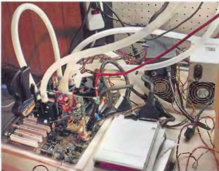
Присутствие элемента Пельтье выдают лишь два толстых проводка под ватерблоком и второй блок питания.
