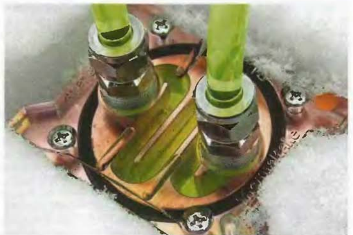
Ватерблок прост – внутри кусок меди прорезан извилистый канал. Сверху его закрывает прозрачная крышка со светодиодной подсветкой.
