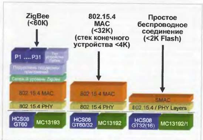
Рис. 4. Реализация беспроводных соединений ZigBee / 802.15.4 на базе плат-формы Freescale Semiconductor.
