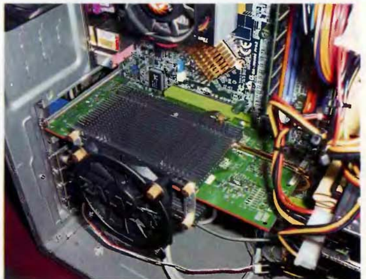
Для охлаждения видеокарт можно применять специальные наборы от производителей систем охлаждения, но не каждый из них нам подойдет.
