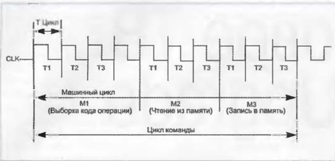
Рис. 3. Подробная схема базового цикла процессора Z80, выпущенного, страшно сказать, аж в 1976 году, почти 30 лет назад.
