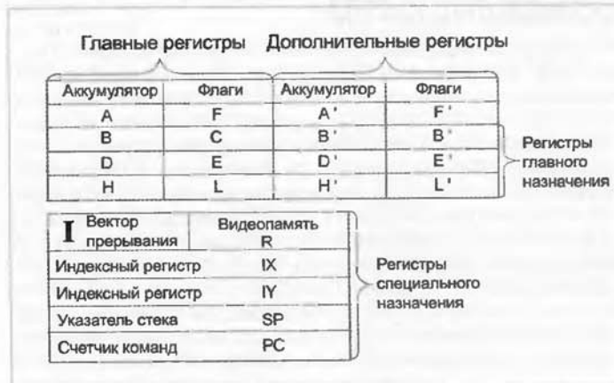
Рис. 2. Конфигурация процессора Z80. Регистры общего назначения повторяют архитектуру регистров 8080.
