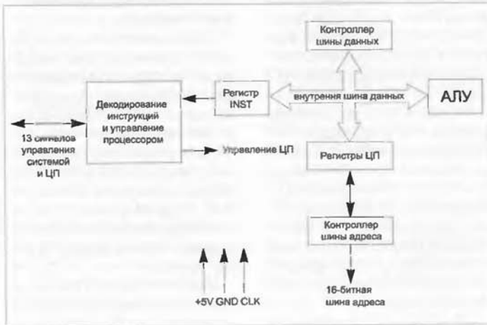
Рис. 1. Принципиальная схема архитектуры процессора Z80. Все узлы обмениваются информацией по внутренней шине данных.
