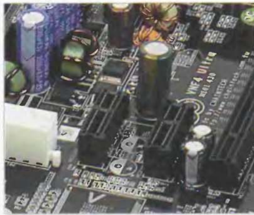
Высокий конденсатор между слотами PCI Express вполне может помешать установке плат в один из разъемов.
