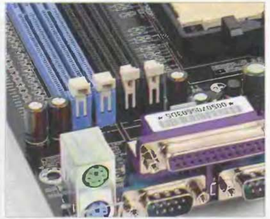
Память на большинстве плат располагается вдоль длинной стороны, тут же слоты развернуты на 90 градусов.
